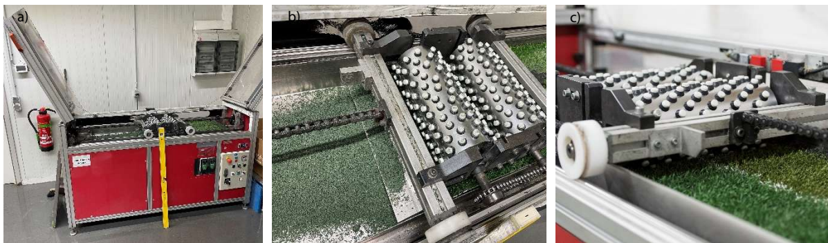
Abb. 4: Mechanische Beanspruchung mittels Lisport-Tester: a) Totale, b) Detailaufnahme Edelstahlwalzen und c) des Prüf-Aufbaus.
