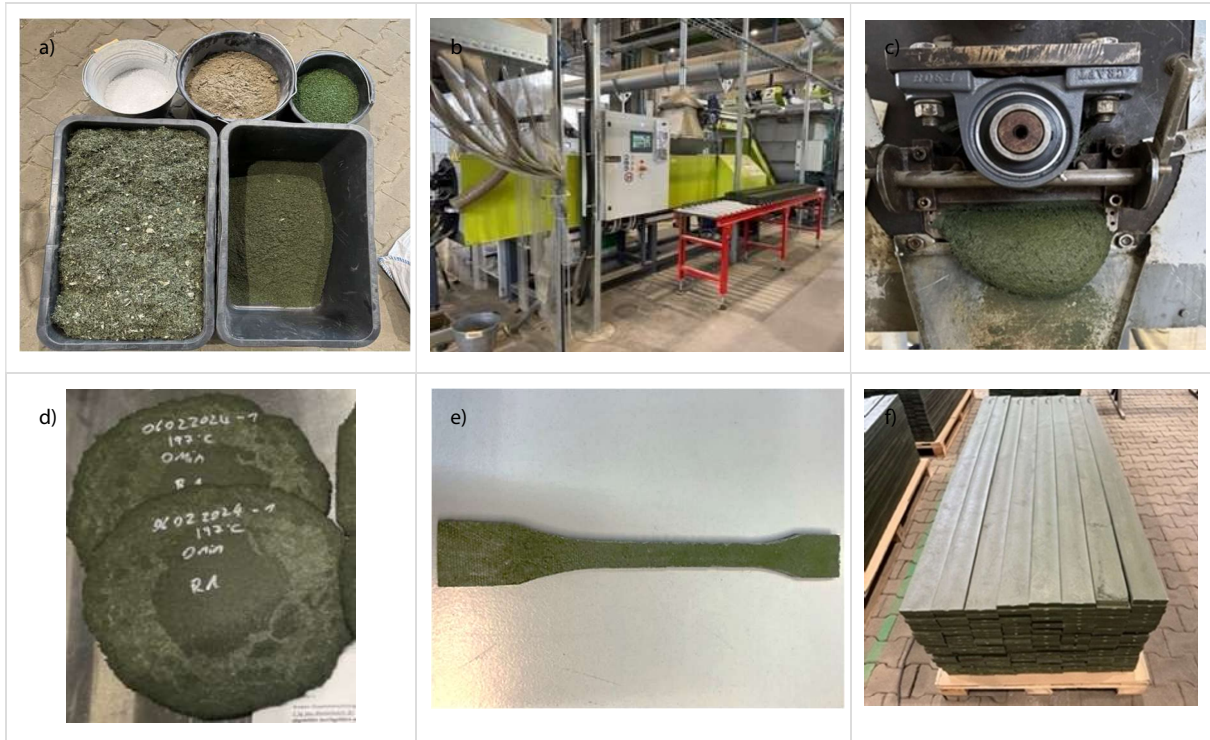
Abb. 7: Recycling-Prozess von Kunststoffrasen: a) Ausgangsmaterialien, b) Aptrusionsanlage, c) Aptrusion der Recyclatmasse, d) ausgehärtete Recyclatmasse, e) Proben-Knochen, f) Endprodukt, z. B. Unterbau für Kunststoffrasenplatz.
