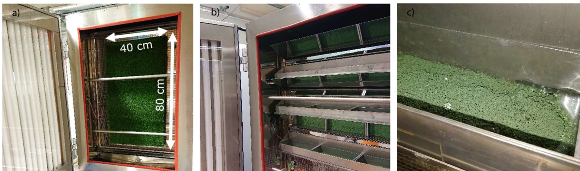
Abb. 3: Umsetzung der UV-Bewitterung. Dargestellt sind die künstliche UV-Beanspruchung im Bewitterungsgerät durch a) vertikale Aufhängung von Kunststoffrasen, b) von EPDM-Granulat in Edelstahlbehältern mittels Umlenkspiegeln und c) Detailaufnahme EPDM-Granulat während der Eis-Phase.
